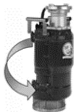
Lorsque le sens de rotation est incorrect, le permutez en deux phases (400 V) (confier cette tâche à un électricien agréé).
