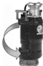
Als de draairichting verkeerd is, moeten twee van de fasen worden verwisseld (400V) (dit alleen door een erkende elektricien laten uitvoeren).
